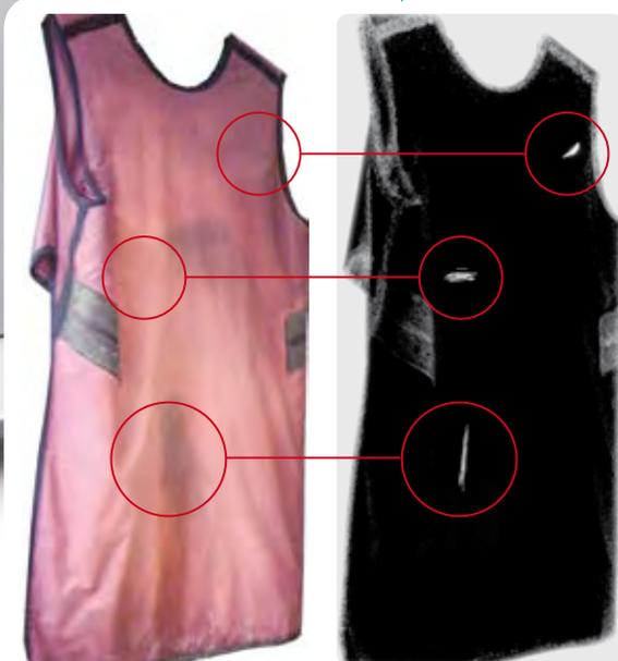
Grazie alla tecnologia **EXAMiRad™** effettuiamo controlli di sicurezza e riparazioni su DPI fessurati, garantendo un processo di verifica, riparazione e controllo sicuro e documentato.
